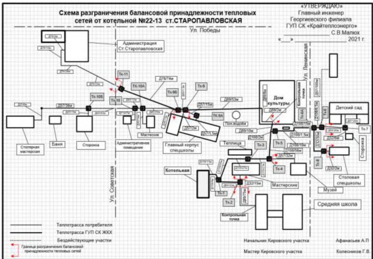
Рисунок 1.1.13 – Зона действия Котельной 22-13
