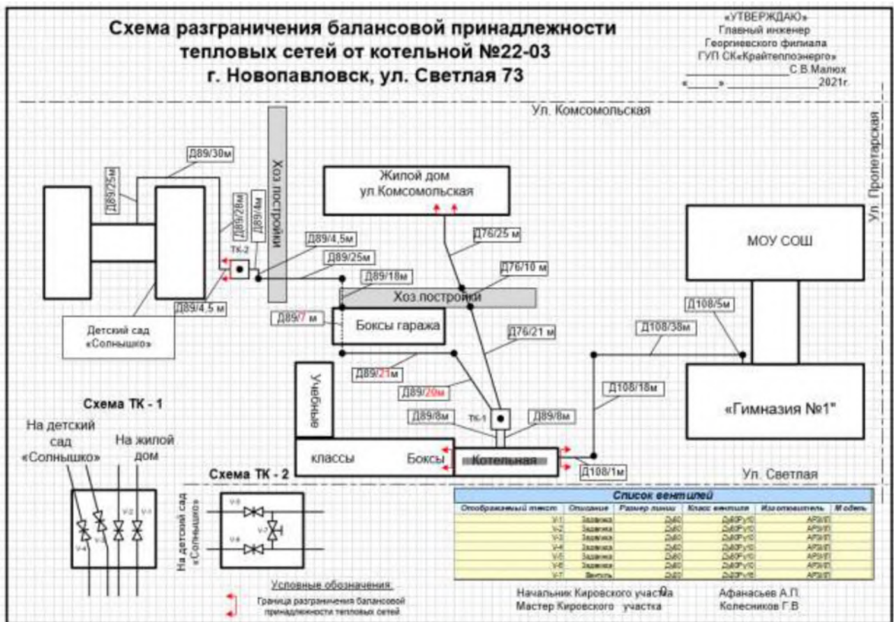
Рисунок 1.1.4 – Зона действия Котельной 22-03
